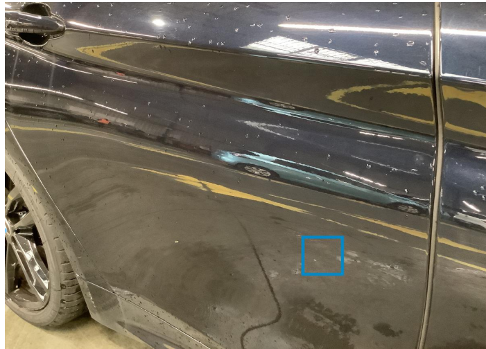
7. Door / Back Right Paint / Chipping -
